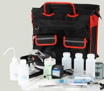
Facile à utiliser, le patch test peut être réalisé par les responsables des machines et représente le système le plus immédiat et sûr pour vérifier le degré de contamination de l'huile et évaluer ainsi le niveau de sécurité et de fiabilité du système.
